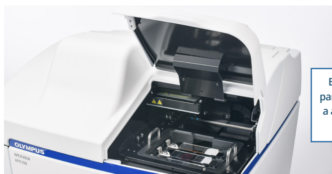
Etapa 1. Abra a tampa e coloque as amostras. O sistema acomoda placas, lâminas, placas de poço, frascos e muito mais.
